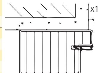
Rechnerische Bodenluft von 4 mm
